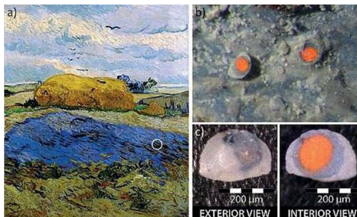
Fig. 52. En la imagen A se puede ver la zona del cuadro de la que se ha extraído la muestra. En las imágenes B y C se ven algunos fragmentos de plumbonacrita: en las zonas protegida del dióxido de carbono (cubierta por otros pigmentos) se conserva el color rojo del minio (B), mientras que en las áreas expuesta al aire el pigmento se ha vuelto completamente blanco (C)
