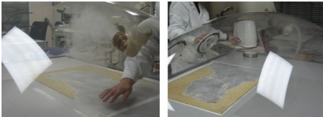
Figuras 23 y 24. Cámara de humectación. Limpieza y desadificación mediante vapor de agua.
