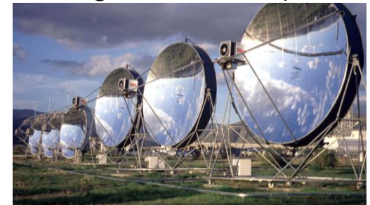
Discos parabólicos (Motores Stirling & ensayo de micro-turbinas; ciclado térmico y envejecimiento acelerado de materiales)
