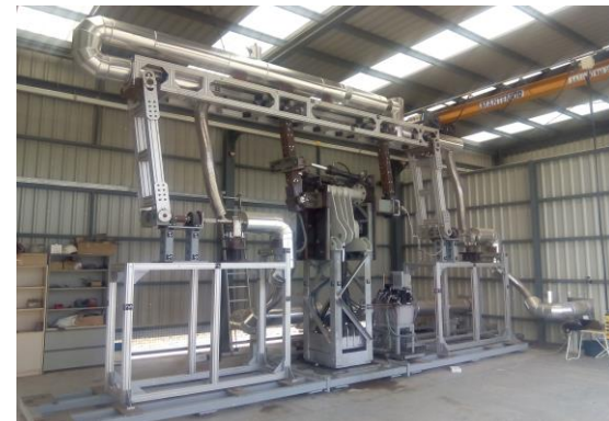
Instalación de ensayo termo-mecánico de juntas rotativas para PTs
