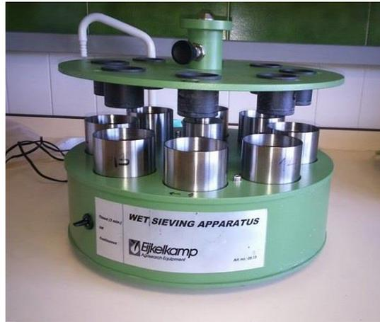
**Figura 6.** Equipo para determinar la estabilidad de los agregados “wet sieving apparatus” de la marca Eijkelkamp.
