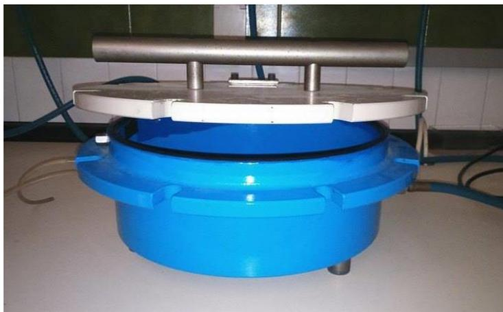
Figura 7. Olla de presión a -33kPa.
